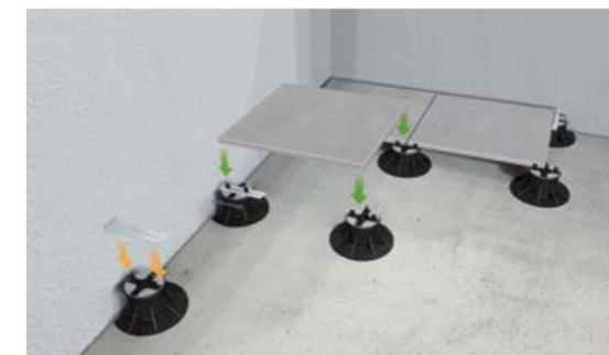
**LA CLIP BORDO PIASTRA SI INCASTRA NELLA PARTE SUPERIORE DEI SUPPORTI ADIACENTI ALLE PARETI CONSENTENDO IL POSIZIONAMENTO DELLE LASTRE A UNA DISTANZA UNIFORME DAI MURI. QUESTO SISTEMA GARANTISCE UNA FUGA PERIMETRALE E AUMENTA LA STABILITÀ DELLA PAVIMENTAZIONE.**
