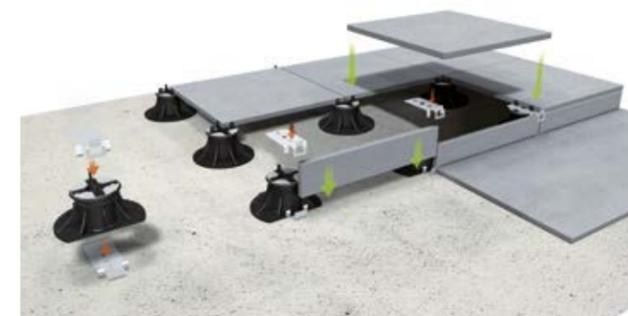
**LA CLIP BORDO VERTICALE CONSENTE DI CHIUDERE LO SPAZIO PERIMETRALE CHE SI CREA IN CORRISPONDENZA DEI BORDI DEL PAVIMENTO SOPRAELEVATO NON ADIACENTI A MURI, OTTENENDO UNA PERFETTA CONTINUITÀ FRA LA SUPERFICIE VERTICALE E IL PIANO DI CAMMINAMENTO. UNA SOLUZIONE COMPOSTA DA DUE CLIP APPLICATE A INCASTRO NELLA PARTE SUPERIORE E INFERIORE DEI SUPPORTI, CHE CREANO LO SPAZIO PER INSERIRE UNA SEZIONE DI GRES TAGLIATO A MISURA.**
