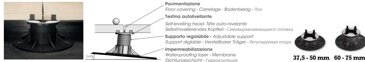
**STRUTTURA REGOLABILE IN ALTEZZA COSTITUITA DA UNA BASE DI APPOGGIO ALLA SOLETTA E UNA TESTA CON SISTEMA DI AUTOREGOLAZIONE DELL'INCLINAZIONE FINO A 5° DI PENDENZA.**
