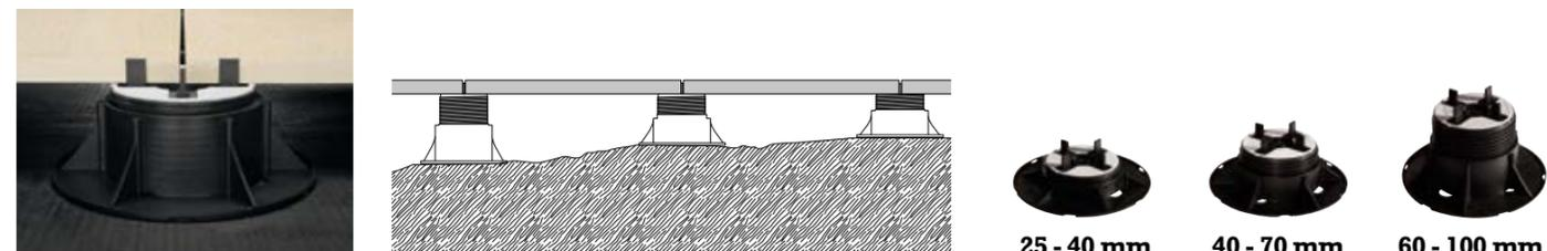
**STRUTTURA REGOLABILE IN ALTEZZA, DA UN MINIMO DI 25 A UN MASSIMO DI 100 MM. UN SISTEMA INTEGRATO NELLA TESTA DEL SUPPORTO NE CONSENTE LA REGOLAZIONE DELL'ALTEZZA SENZA LA RIMOZIONE DEI PANNELLI.**
